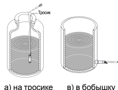
Рисунок 3.1 – Примеры монтажа на объекте
