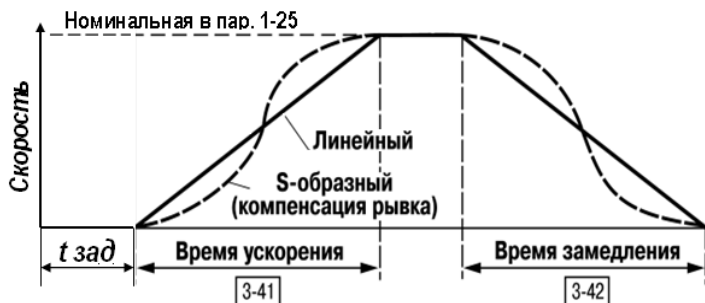
Рисунок 2.1 – Характеристики разгона/замедления
