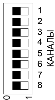
Рисунок 5.9 – DIP-переключатели на корпусе модуля для подключения резисторов
