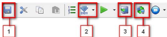
Рисунок В.10 – Панель конфигурирования КСОД. 1- Сохранить проект, 2 - построить конфигурацию для верхнего уровня, 3 – загрузка конфигурации в КСОД, 4 – запуск глобального опроса (всех устройств)
